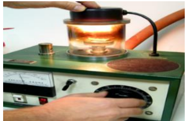
شکل ۵ پوشش دهی نمونه‌ها با طلا
