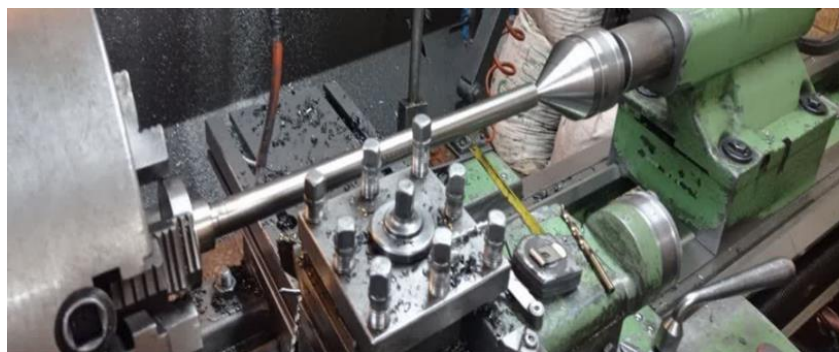
شکل ۱ شفت اینکونل حین تست ماشینکاری
