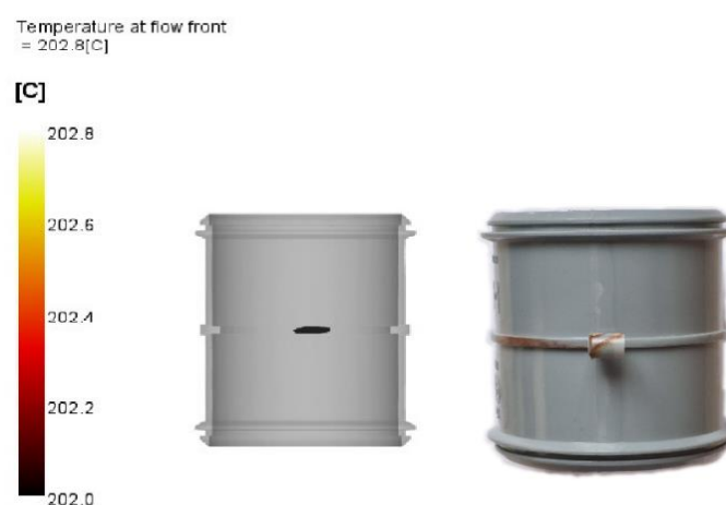
شکل ۱۲ عیب سوختگی در آزمایش ۲
