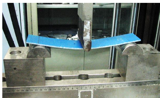
شکل ۲ چیدمان بارگذاری مربوط به آزمایش سه نقطه خمشی در مورد نمونه FS1
