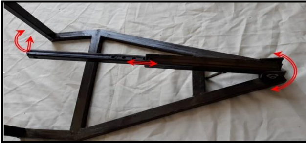
شکل ۴ پایه نگه‌دارنده و بازوی متحرک جهت تنظیم زاویه در سه بعد
