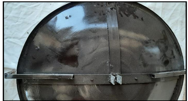
شکل ۳ استفاده از تسمه آهنی برای استحکام و اتصال
