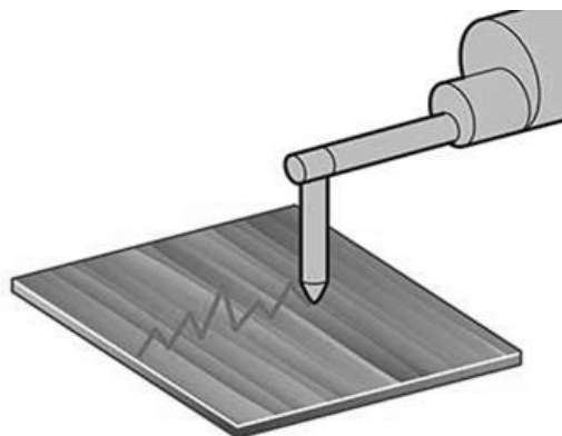
شکل ۲ نحوه اندازه گیری زبری سطح
