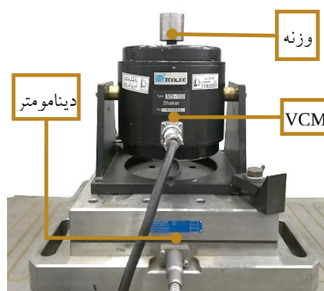
شکل ۲ نصب وزنه‌ها بر روی عملگر و اتصال آن به دینامومتر
