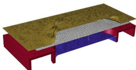
شکل ۱۷ مدل سه‌بعدی مونتاژی اجزای قالب و قطعه ورقی در نرم‌افزار آباکوس
