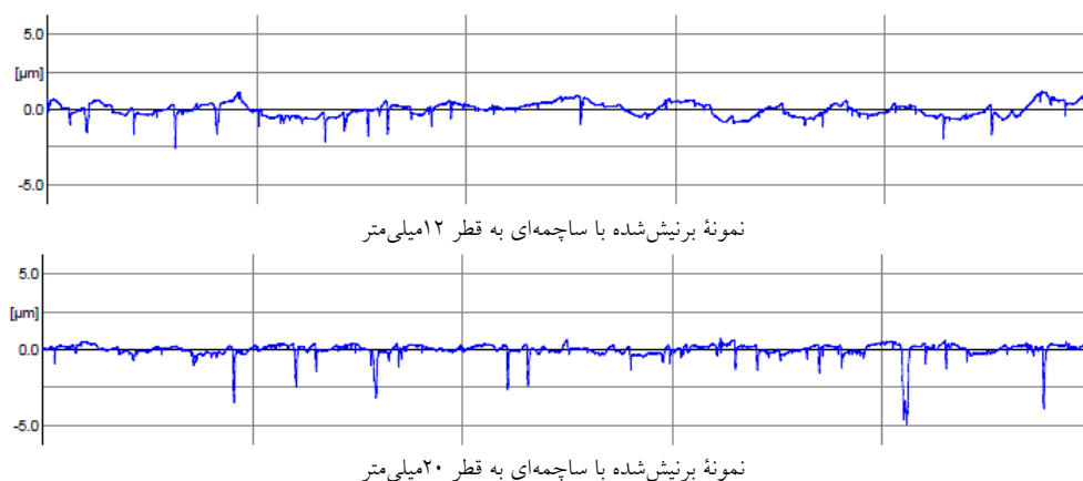
شکل ۱۰ پروفیل زبری سطح، حاصل از فرایند برنیشینگ ساچمه ای با ۲ قطر متفاوت ساچمه
