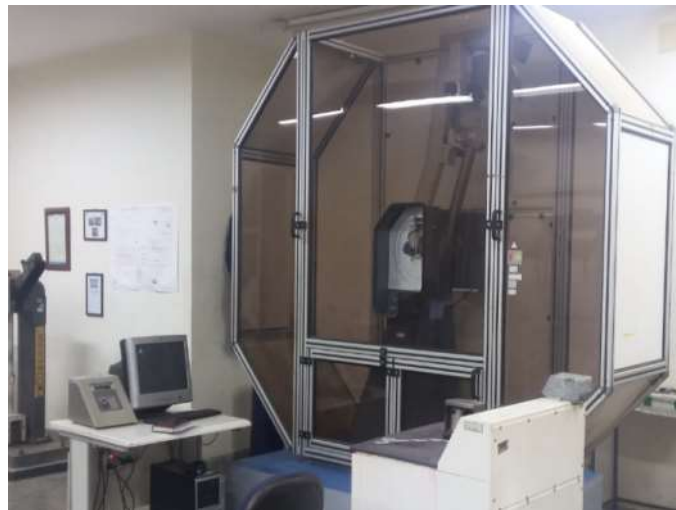
شکل (۲): ماشین ضربه شاری زوئیک رول آلمان
