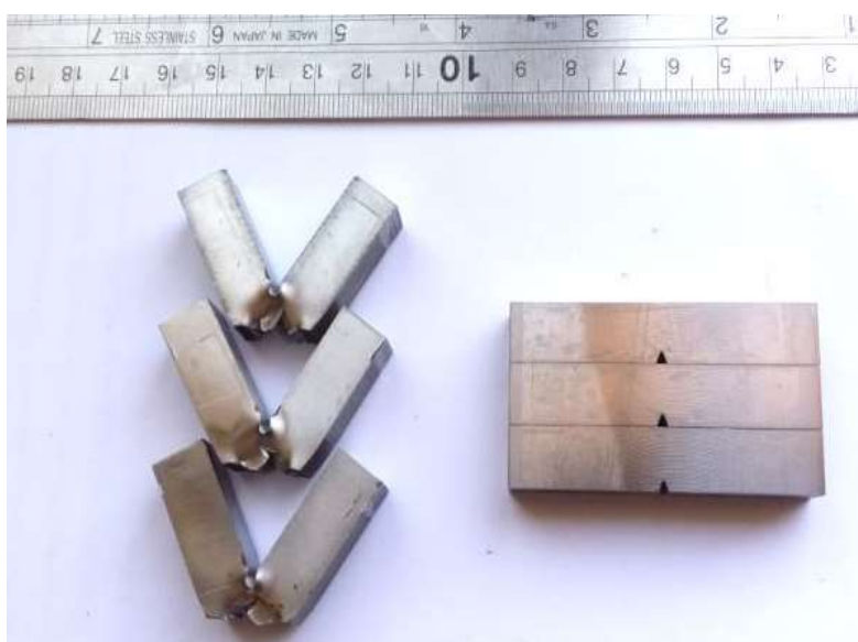
شکل (۳): یک گروه سه‌تایی (با عمق شیار استاندارد) از نمونه آزمایش شاری قبل و بعد شکست [۳۵]
