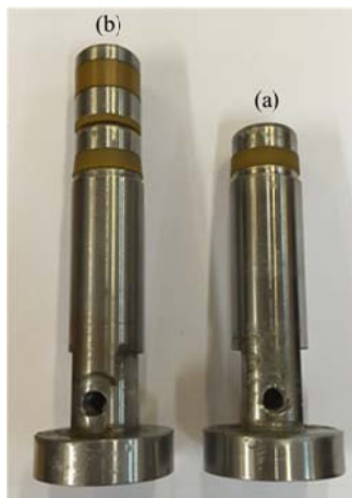
شکل ۶ سنبه (الف) روش آب‌بندی متداول، (ب) روش آب‌بندی جدید
