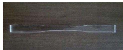
شکل ۶ نمونه تست کشش پی.ام.آ
