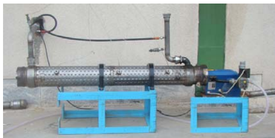
شکل ۴ آزمایش لوله دوجداره با سوخت متان
