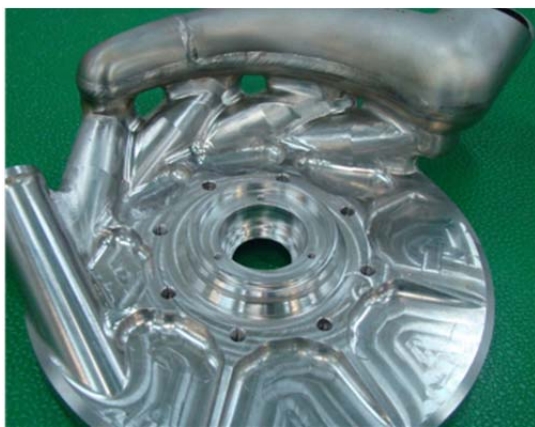
شکل ۱ استاتور و نازل های توربین فراصوت ضربه ای مدل پایه
