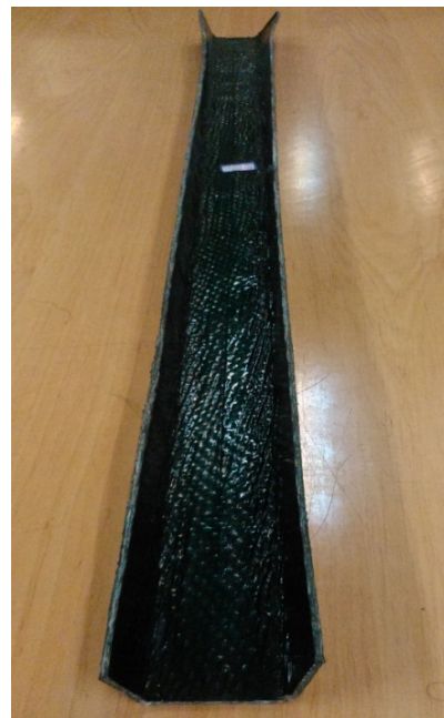
شکل ۹ نمونه ای از ورق کامپوزیتی با چیدمان [0/90] ، شکل دهی غلتکی شده به پروفیل کانالی با زوایای 0, 30, 60 و 86 درجه
