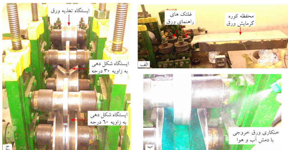
شکل ۲. مجموعه های شکل دهی غلتکی ورق های کامپوزیتی، الف) سیستم گرمایش ورق در ابتدای خط شکل دهی، ب) سیستم خنکاری دمش آب و هوا در انتهای خط شکل دهی، ج) ماشین شکل دهی غلتکی (غلتک های تغذیه ورق و شکل دهی)
