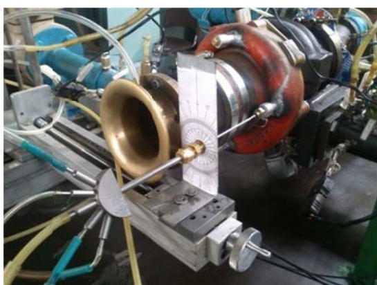
شکل ۱۳ کاوشگر نصب شده در موقعیت ۲ (شکل ۱۲) و سیستم حرکت عرضی و چرخشی آن
