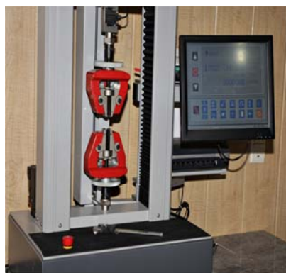
شکل ۳ دستگاه تست کشش یونیورسال هیدرولیک GT-7001-LC
