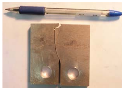
شکل ۵ نمایی از قطعه پس از شکست نهایی
