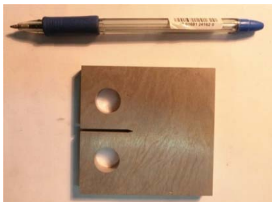
شکل ۲ نمونه CT ساخته شده توسط فرآیند وایرکات
