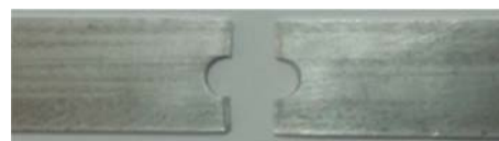
شکل ۱۰ قطعه آزمایش سوم بعد از شکست
