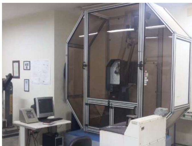
شکل (۲): ماشین ضربه شاریبی زوئیک رول آلمان
