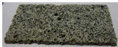
شکل ۳ ورق فوم حفره‌بسته آلومینیم وایرکات شده
