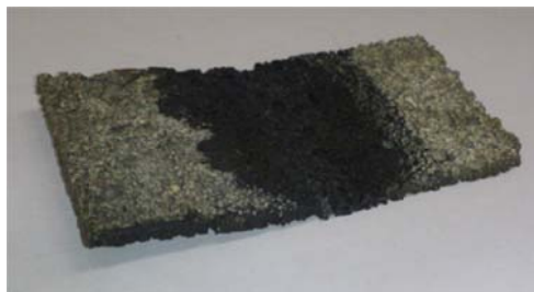
شکل ۵ ورق فوم آلومینیم خم شده با استفاده از لیزر
