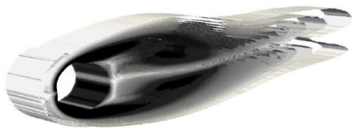
شکل ۵ میدان ورتیسیتی \omega/(U/D) , min:-43 ; max: 43
