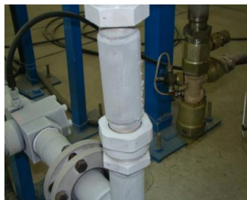
شکل ۳ یخ بستن لوله پس از کاهش فشار
