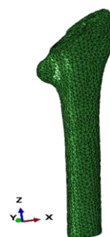
شکل ۱۶ نمایی کامل از استخوان شبکه بندی شده با المان های C3D10
