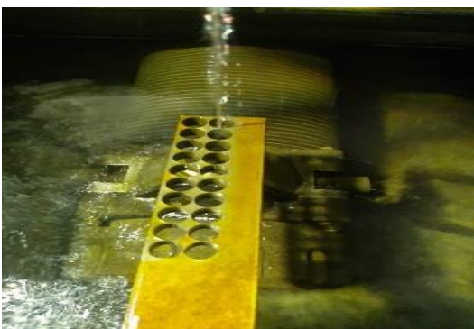
شکل ۲ دستگاه وایرکات پنج محوره و قید و بند قطعه‌کار بر روی آن
