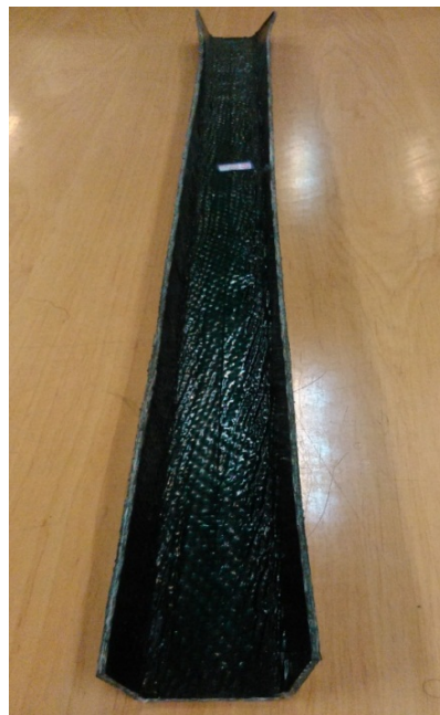
شکل ۹ نمونه‌ای از ورق کامپوزیتی با چیدمان [۰/۹۰]، شکل‌دهی غلتکی شده به پروفیل کانالی با زوایای ۰,۳۰,۶۰ و ۸۶ درجه
