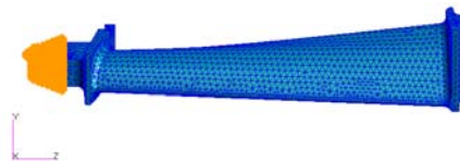
شکل ۳ شرایط مرزی در حالت ثابت (مانند تیر یکسرگیردار و در دمای محیط)
