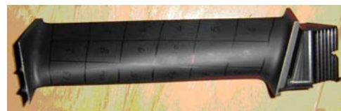
شکل ۷ نحوه تست آزمایشی پره در آزمایشگاه در حالت آزاد-آزاد
