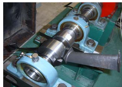
شکل ۲ نحوه تست آزمایشی پره در آزمایشگاه
