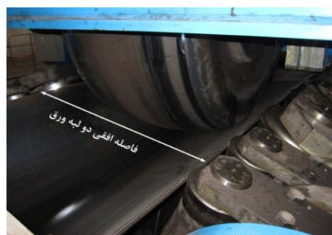
شکل ۱۹ نحوه اندازه‌گیری فاصله افقی دو لبه ورق
