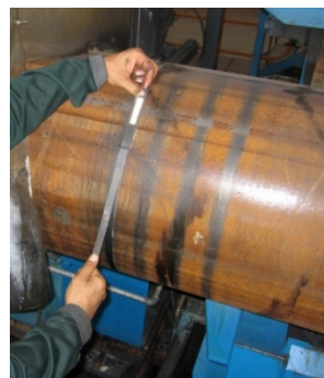
شکل ۱۸ نحوه اندازه‌گیری محیط خارجی ورق تغییر شکل یافته
