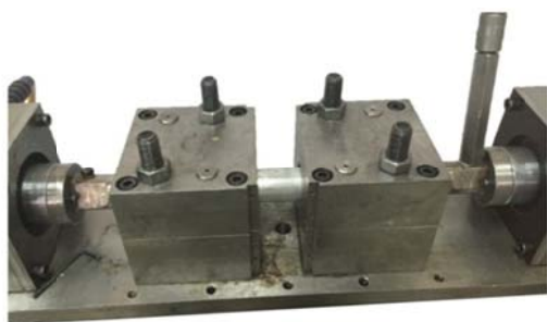
شکل ۵ دستگاه بالج آزاد لوله
