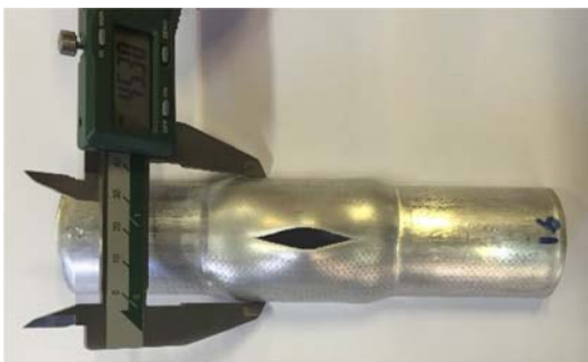
شکل ۸ روش اندازه‌گیری ارتفاع بالچ
