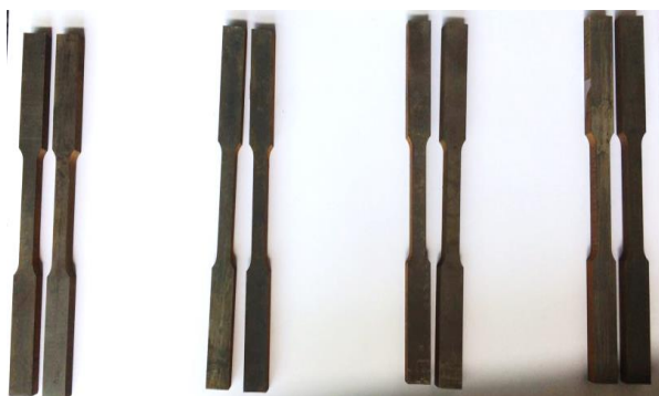
شکل ۷ نمونه‌های استاندارد تست کشش
