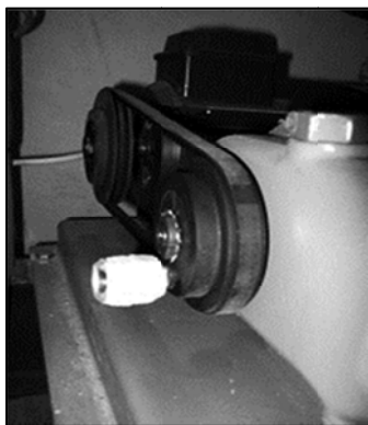
شکل ۱۰ کمپرسور نابالانس شده
