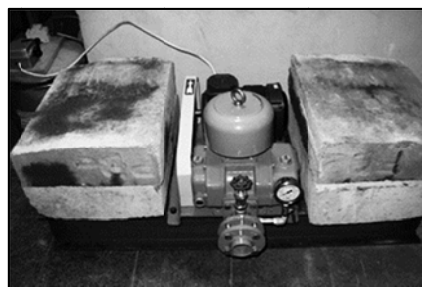
شکل ۸ کمپرسور سه‌باله‌ای به همراه فونداسیون تعبیه‌شده
