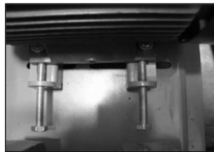
شکل ۱۱ کمپرسور نامیزان شده
