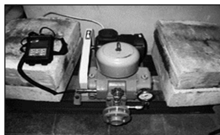
شکل ۹ نمایی از دستگاه داده‌برداری به همراه کمپرسور مورد آزمایش
