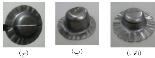
شکل ۱۲ انواع پارگی در شکل‌دهی هیدرومکانیکی لوح‌های ترکیبی: (الف) شعاع سر سنبه در بخش نازک‌تر لوح؛ (ب) شعاع رینگ کشش در بخش نازک‌تر لوح؛ (ج) ناحیه‌ی جوش
