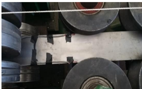
شکل ۱۲ استفاده از کرنش‌سنج‌ها بر روی صفحه بالایی ورق: استفاده از غلتک‌های راهنما به منظور هدایت ورق به داخل ایستگاه (چپ)، غلتک‌های ایستگاه شکل‌دهی (راست)
