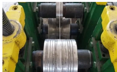
شکل ۱۲ استفاده از کرنش‌سنج‌ها بر روی صفحه بالایی ورق: استفاده از غلتک‌های راهنما به منظور هدایت ورق به داخل ایستگاه (چپ)، غلتک‌های ایستگاه شکل‌دهی (راست)
