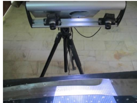
شکل ۱۳ اسکتر نوری برای اندازه‌گیری عیوب پیش و انحنای طولی
