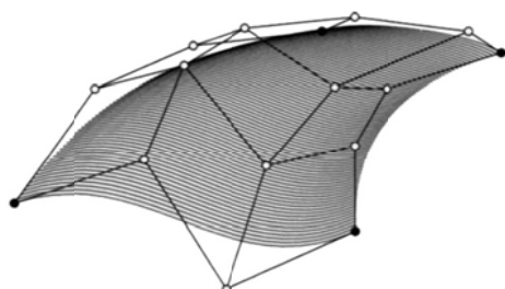
شکل ۱ شبکه نقاط کنترلی و سطح نریز مربوط به آن با توابع پایه درجه دو
