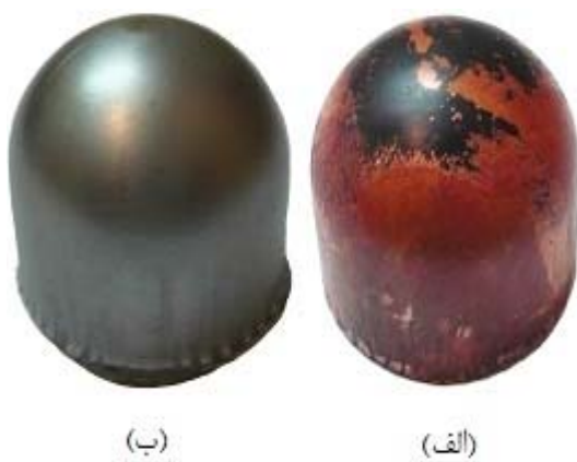
شکل ۷ قطعات شکل داده شده در آزمایش‌های تجربی (الف)- مس خالص، (ب)- فولاد St14
