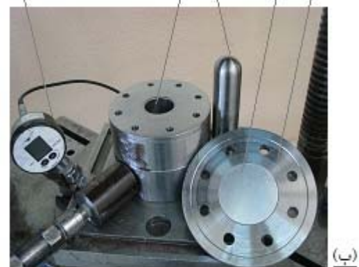
شکل ۵ الف- دستگاه پرس و واحد هیدرولیکی مورد استفاده در آزمایش‌ها ب- مجموعه قالب ساخته شده
