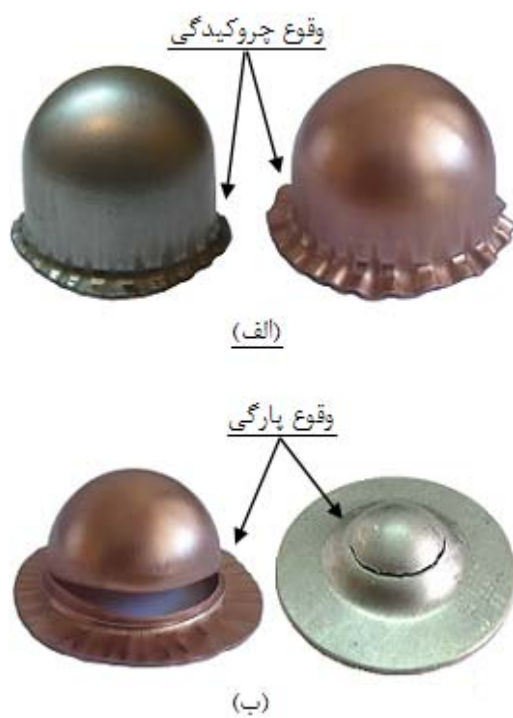
شکل ۲ نمونه‌ای از عیوب ایجاد شده در آزمایش‌ها تجربی انجام شده در این پژوهش (الف- عیوب چروکیدگی ب- عیوب پارگی)
