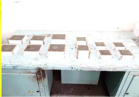
(ب) بتن‌ریزی قالب‌ها
