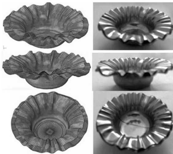
شکل ۱۰ مقایسه ی نتایج شبیه سازی رایانه ای و روش تجربی فرآیند کشش عمیق در نمونه ی شماره ی ۱۲
