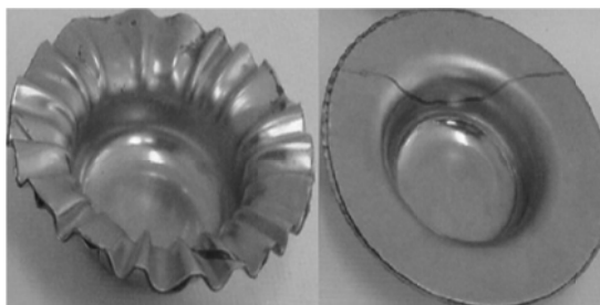
شکل ۸ مقایسه‌ی نمونه‌ی سالم (نیروی ورقگیر 4.65kN) و چین‌خورده (نیروی ورقگیر 0.71kN)
