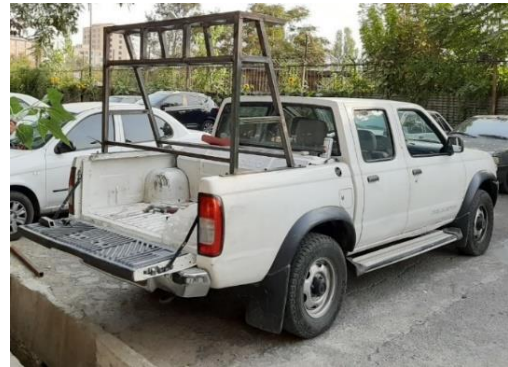
شکل ۱۲ سازه فلزی متصل بر روی خودرو پیکاپ
