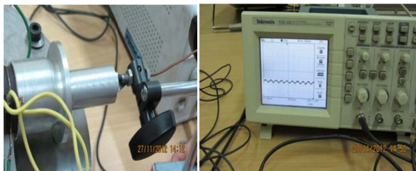
شکل ۱۸ اندازه‌گیری دامنه ارتعاش ابزار ارتعاشی دوبعدی
