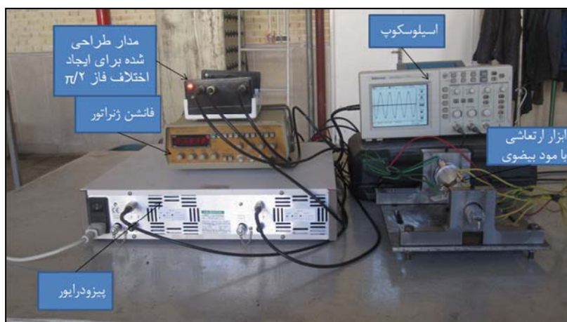
شکل ۱۷ تجهیزات کنترلی ابزار ارتعاشی تراش کاری با مود بیضوی
