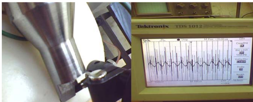
شکل ۱۰ اندازه‌گیری دامنه ارتعاش ابزار ارتعاشی با مود خمشی
