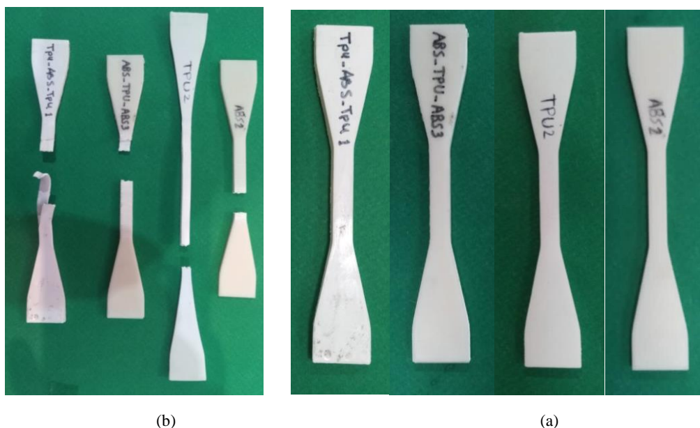
شکل ۱۰ نمونه‌های (a) قبل و (b) بعد از تست کشش
