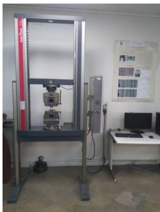
شکل ۳ دستگاه تست کشش ZWICK ROELL
