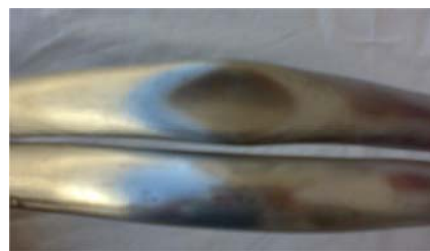
شکل ۱۵ فرورفتگی شعاع خارجی خم [خم ایجاد شده با استفاده از ماندل سیمی (پایین) و خم ایجاد شده بدون استفاده از ماندل سیمی (بالا)]
