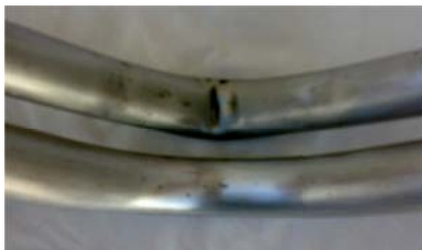
شکل ۹ چروکیدگی در شعاع داخلی خم [خم ایجاد شده با استفاده از ماندل سیمی (پایین) و خم ایجاد شده بدون استفاده از ماندل سیمی (بالا)]
