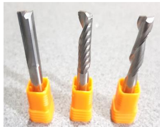
شکل ۷ ابزارهای ۶ میلی‌متر به ترتیب از راست به چپ: دوپر مارپیچ، تک پر مارپیچ، دو پر مستقیم
