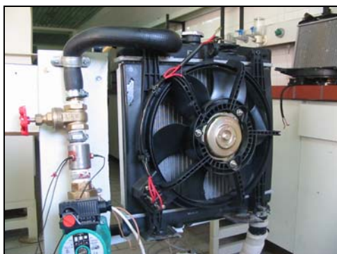
شکل ۵ بستر آزمون رادیاتور و فن
