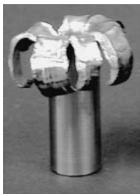
شکل ۲ پاره شدن ورق در یک جاذب انرژی جدار ضخیم [4]
