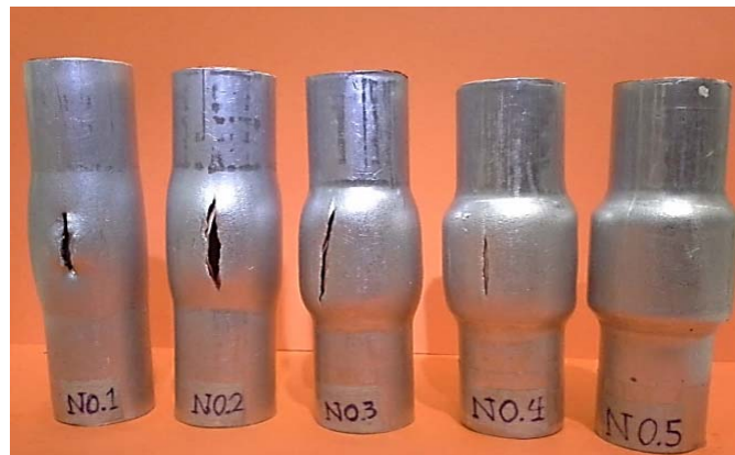
شکل ۳۱ نقش تغذیه محوری در شکل‌دهی سالم قطعه
