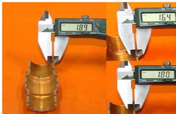
شکل ۳۲ اندازه‌گیری ضخامت نمونه برش‌خورده
