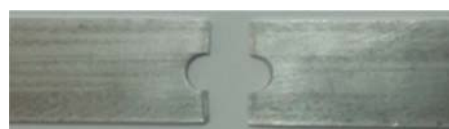
شکل ۱۰ قطعه آزمایش سوم بعد از شکست
