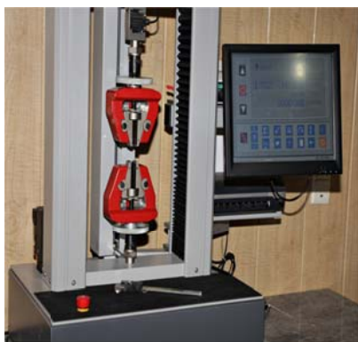
شکل ۳ دستگاه تست کشش یونیورسال هیدرولیک GT-7001-LC
