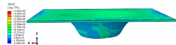
شکل ۹ توزیع تنش سه‌محوری در هندسه مخروط ناقص در یک فریم مانده با شروع شکست
