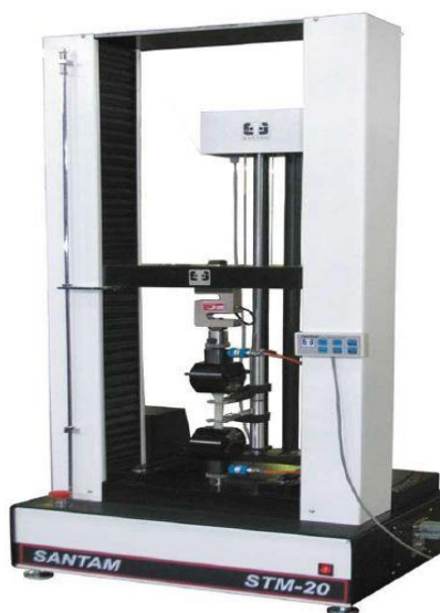
شکل ۶ دستگاه اندازه‌گیری خواص مکانیکی (کششی) لاستیک‌های پخت شده
