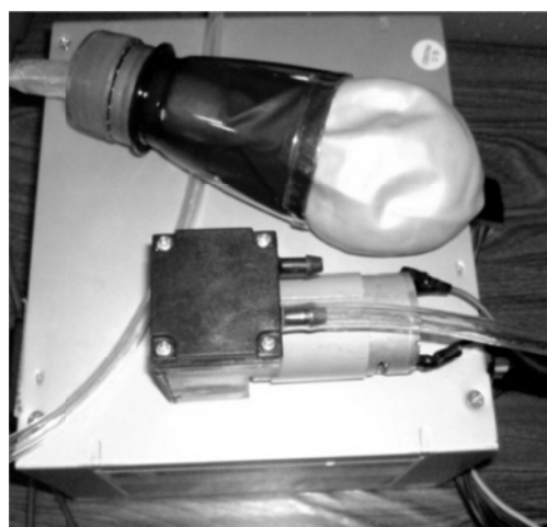
شکل ۵ مدل اولیه‌ی گیره‌ی بالنی رباتیک در کنار پمپ مکش و منبع تغذیه
