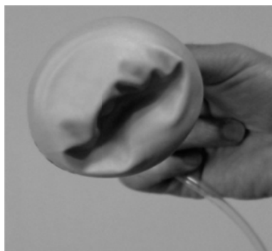
شکل ۷ قالب ایجاد شده از یک حلقه روی غشا بالن اصلی (در این وضعیت قطعه برداشته شده است و سپس جدا شده تا قالب گرفته شده از آن نشان داده شود)
