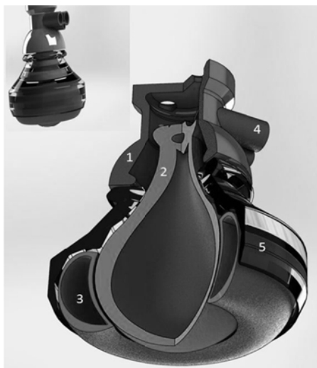
شکل ۱ طرح سه‌بعدی گیره‌ی رباتیک
