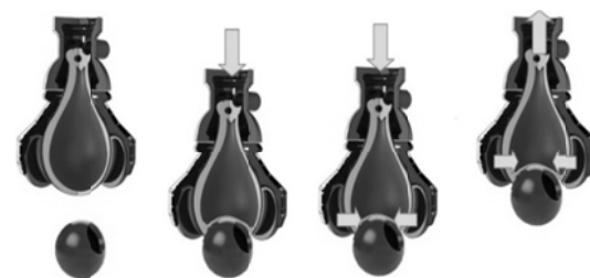
شکل ۴ نحوه‌ی کارکرد گیره‌ی بالنی
