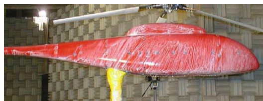
شکل ۸ مدل بالگرد نصب‌شده در تونل باد و پایه‌ی نگه‌دارنده‌ی آن [16]
