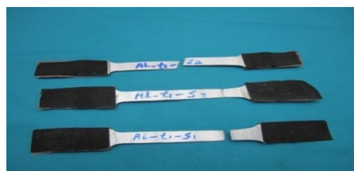
شکل ۲ نمونه‌های تست کشش برای تعیین مشخصات مکانیکی ورق آلومینیومی
