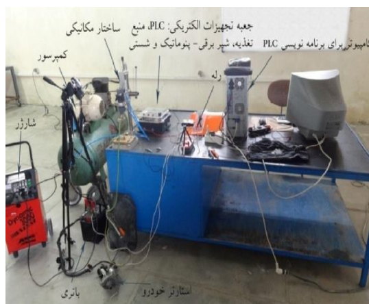
شکل ۶ Set-up ساخته شده و اجزای آن
