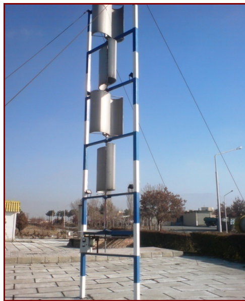
شکل ۲۱ نمای روتور ساونیوس با پره های پیشرفته که در سایت مشکین دشت کرج نصب شده و درحال کار می باشد [۸]
