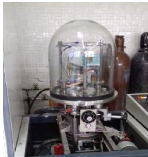
شکل ۸ پمپ خلأ دو مرحله‌ای شرکت Edwards با محفظه شفاف شیشه‌ای
