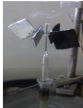
شکل ۳ مجموعه ثابت شامل سوزن و پایه نگهدارنده محل اتصال کلاهک شیشه ای به سوزن که در صورت منحرف شدن نوک سوزن از مرکز ثقل به علت نیروی وزن دوباره به جای خود بازمی گردد.
