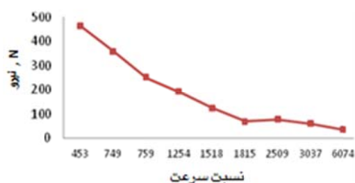
شکل ۲۳ تأثیر نسبت سرعت SR روی نیروی محوری در فرآیند سوراخ‌کاری ارتعاشی، متنه 8\text{mm}
