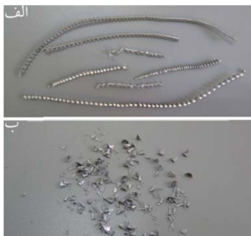
شکل ۲۴ تأثیر ارتعاشات اولتراسونیک بر روی شکل براده، الف) سوراخ‌کاری معمولی، ب) سوراخ‌کاری ارتعاشی
