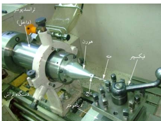
شکل ۱۶ مجموعه سوراخ‌کاری ارتعاشی چرخشی، متنه ۵mm
