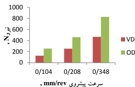
شکل ۲۱ نمودار تغییرات نیرو نسبت به پیش‌روی در سرعت برشی ۳۸۰ rev/min، مته ۸mm
