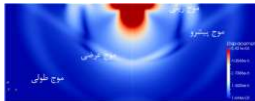
شکل ۷ میدان فراصوتی ایجادشده در زمان ۶۴۰ نانوثانیه پس از تابش لیزر با توان ۱۰ میلی‌ژول و خیزپالس ۵ نانوثانیه
